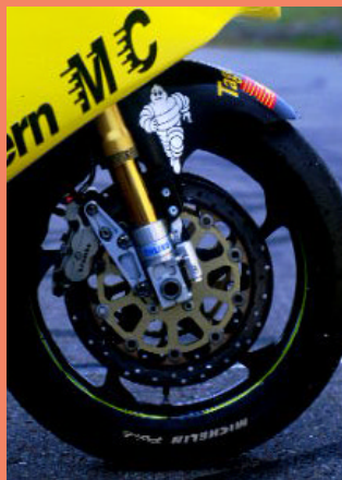
Öhlins forgaffel gir god fjæring, og Brembo-bremser gir godt bitt.
