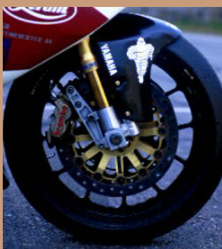
Velkjent kombinasjon? Öhlins forgaffel og Brembo firestemplede kalipere..
